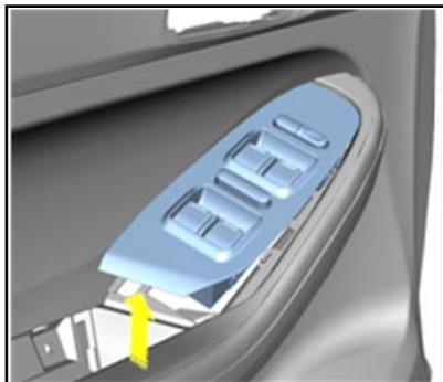
3.1.11、按图示箭头方向按住内开手柄卡座，取下内开手柄总成。
