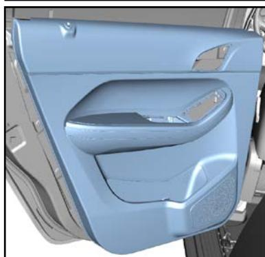
3. 1. 5、用内饰撬棒拆下后门前护盖总成。
