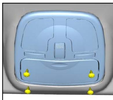
3.3.4、拔下顶灯插件，取下顶灯总成。
