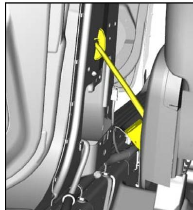
3.11.3、用棘轮扳手和 13#套筒拆下后车门与门铰链上下 的 4 个固定螺栓，取下后车门总成。
