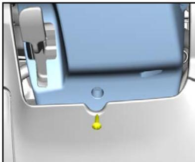
4.1.7、用内饰撬棒拆开上下护罩，取下下护罩。
