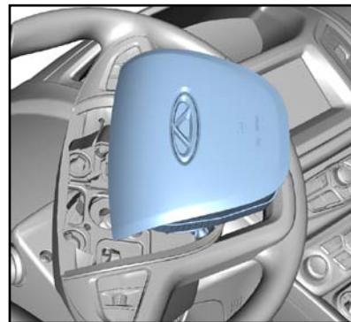
4.1.3、车轮方向打正，使用力矩扳手和 22#套筒拆下
