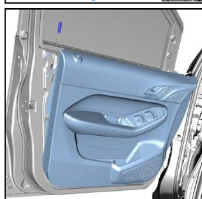
3.1.10、用内饰撬棒拆下组合开关总成。
