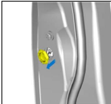
3.8.2、使用十字螺丝刀拆下锁芯总成固定螺栓。
