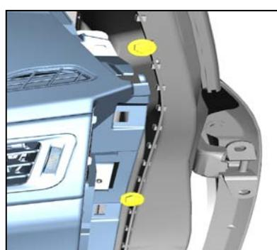
1. 1. 10、用棘轮扳手和 10#套筒拆下仪表板右侧下部与仪表横梁支架的固定螺栓。
