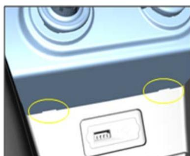
3. 2. 3、拔下点烟器的插接件，取下点烟器面板总成，拔下点烟器手柄，用一字螺丝刀插入座孔壁两侧卡槽，退出点烟器。
