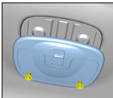
3.4.3、拔下后顶灯插接件，取下后顶灯。
