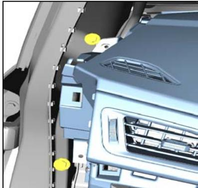
1. 1. 5、用棘轮扳手和 10#套筒拆下仪表板转向管柱处与仪表横梁的固定螺栓。
