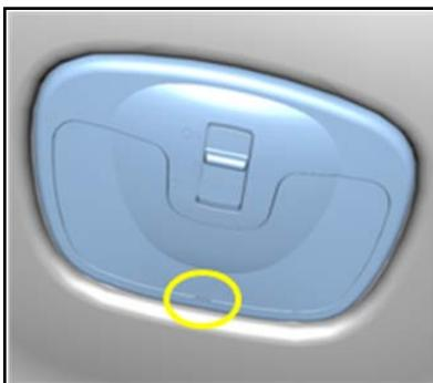
3.4.2、用棘轮扳手和 8#套筒拆下后顶灯固定螺栓。
