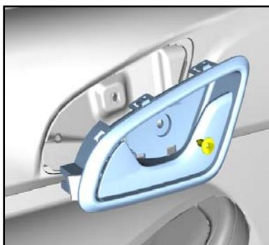
3. 1. 2、用内饰撬棒拆下后门拉手盒固定螺钉的堵盖。
