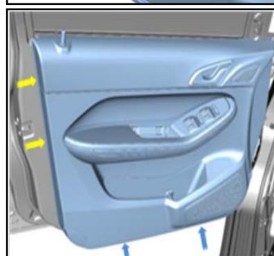
3. 1. 9、拆下内开手柄拉线及组合开关和高音扬声器的插件，取下门护板。
