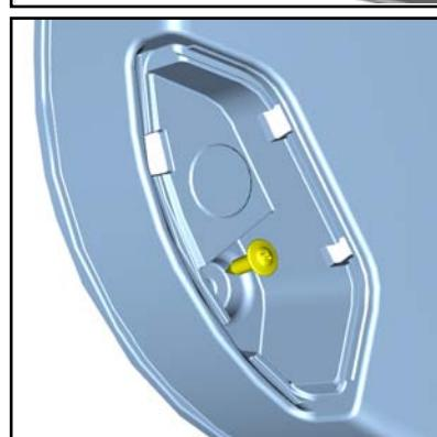
3. 1. 8、用卡扣撬棒拆下门护板与钣金的固定塑料卡扣。
