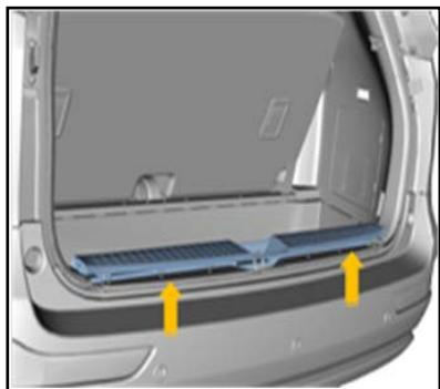
3.1.7、用十字螺丝刀拆下行李箱地板总成左右的固定螺钉。
