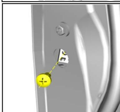
3.8.3、脱开锁芯总成与门锁总成的拉杆。
