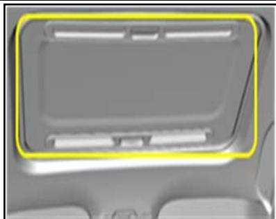
3.7.3、拆下顶棚总成，从后背门处取出顶棚总成。
